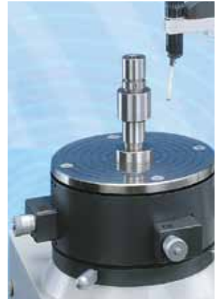
Servo motorlu mikrometreler (AAT) kullanarak otomatik iş parçası hizalama
