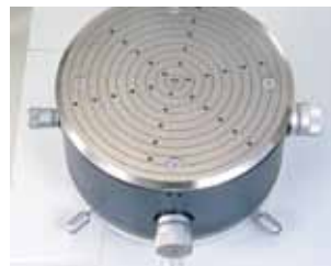
Servo motorlu mikrometreler (AAT) kullanarak otomatik iş parçası hizalama
