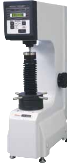
HR-430MR 963-240 Rockwell sertlik test cihazı Ekonomik model olmasına rağmen, tuşla teste başlama, motorize güç yönlendirme ve birçok test standartını destekleyebilme özelliklerine sahiptir. Ayrıca cihaz otomatik fren ve elle otomatik başlatma özelliği ile donatılmıştır. Yükleme sırası motorize sürücü tarafından kontrol edilir.
