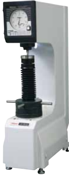
HR-210MR 963-220 Rockwell sertlik test cihazı Manuel ağırlık değişimi (toplam test yükü seçimli) ve önyüklemeye kullanımlı. Motor sürücüsü yüklemeye kontrol eder.
