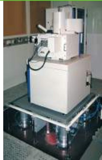
Uygulama örneği: Titreşim yalıtım platformunda elektron mikroskobu
