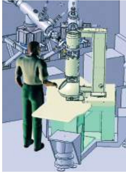
Titreşim yalıtım platformunda elektron mikroskobu
