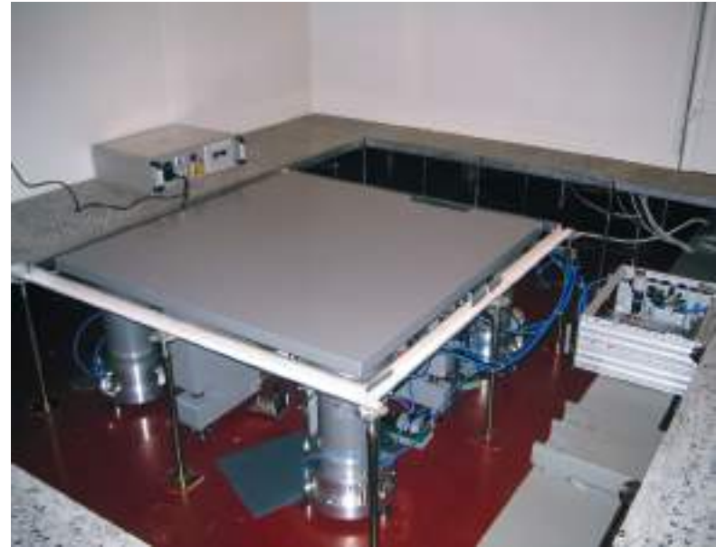
Titreşim piklerinin azaltılması için ek kütleli çift / temiz oda zeminlerine entegrasyon platformu
