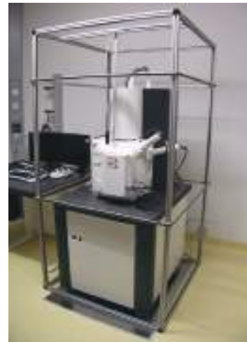
Manyetik alan telafisi için Bilz'den entegre bobin çerçevesi
