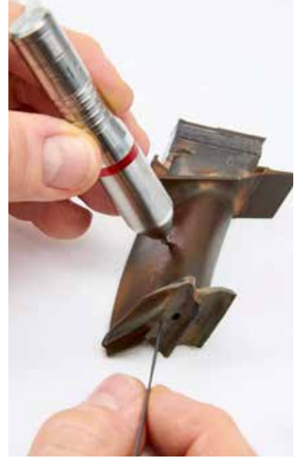
FH4-WIRE: Türbin bileşenlerinin ölçülmesi
