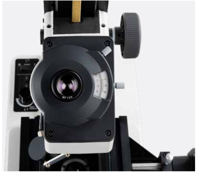
Göz merceğinin dışına monte edilmiş bir verniyer skalası, basit açı ölçümü sağlar.
