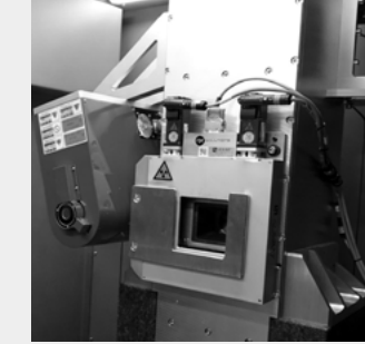
Çift Tüp 5 µm çözünürlük için 150 kV tüp ilavesi
