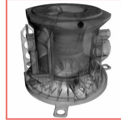
Hidrojen Yakıcı Eklemeli İmalat 450 kV. Çözünürlük: 45 µm
