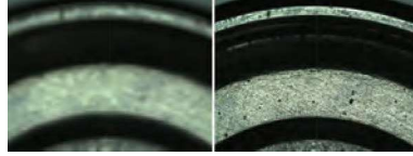
Ekran resmi önce ve Oto fokus sonrası. Opsiyonel Vision ünite kullanıldığında
