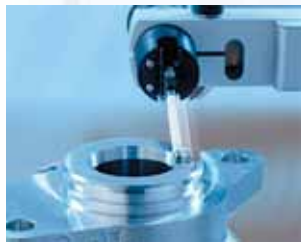
Spiral hat boyunca düzlemsellik ölçümü
