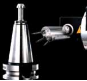
Prob sistemi 1° adımlarla pozisyonlanabilir
