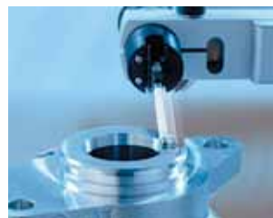
Spiral hat boyunca düzensellik ölçümü
